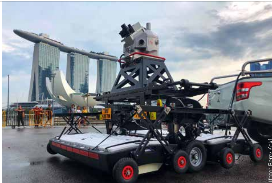
Grondradar om de ondergrond in kaart te brengen.
